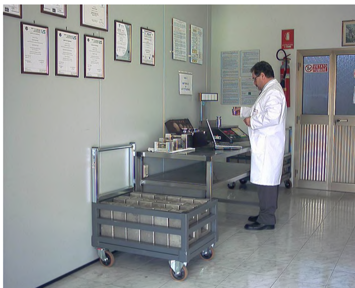
Operazioni di verifica periodica su strumento per pesare a funzionamento non automatico
