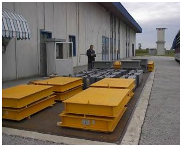
Taratura di una pesa a ponte per autocarri
