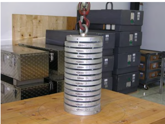
Taratura di una massa a grappolo
