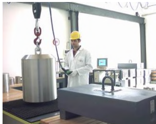
Taratura di una massa da 1000kg
